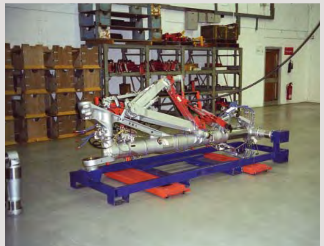
Fahrgestell wird einfach bewegt in der Montagestrasse
