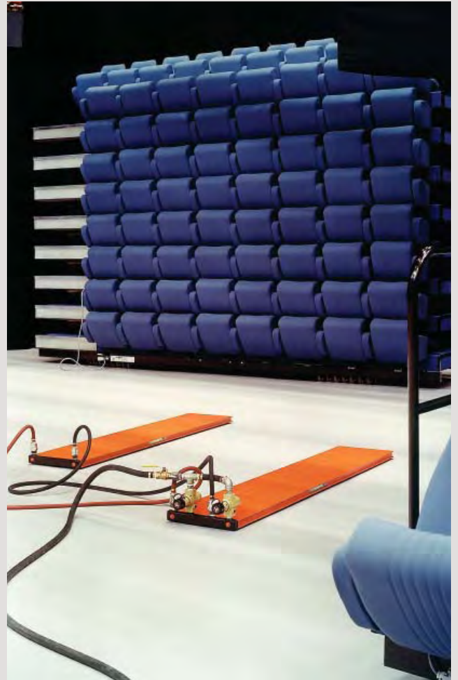
Bewegen von Tribünen über empfindliche Fußböden von Sporthallen, Fernsehstudios usw.
